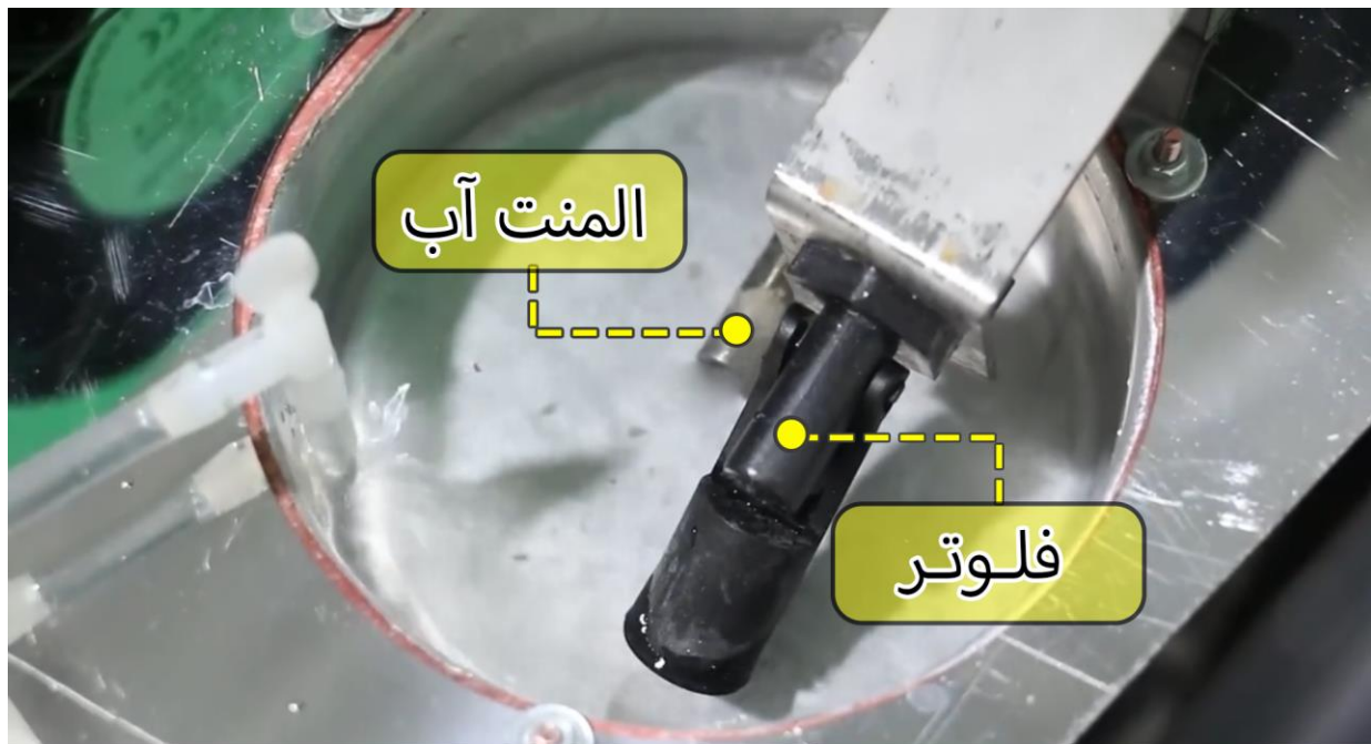
سیستم رطوبت ساز دستگاه های درنا ( مخزن آمینومی ، المنت فشنگی مخصوص ، فلوتر، شلنگ خروجی پمپ آب )
